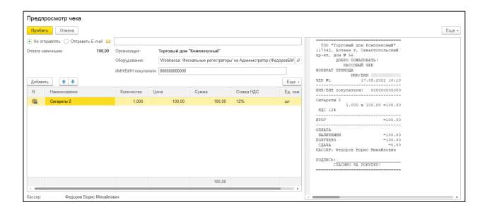
В фискальном чеке ККМ у возвращаемого товара отражается код маркировки. Таким образом, товар с данным кодом маркировки будет снова введен в оборот на стороне сервиса ИС МПТ.
